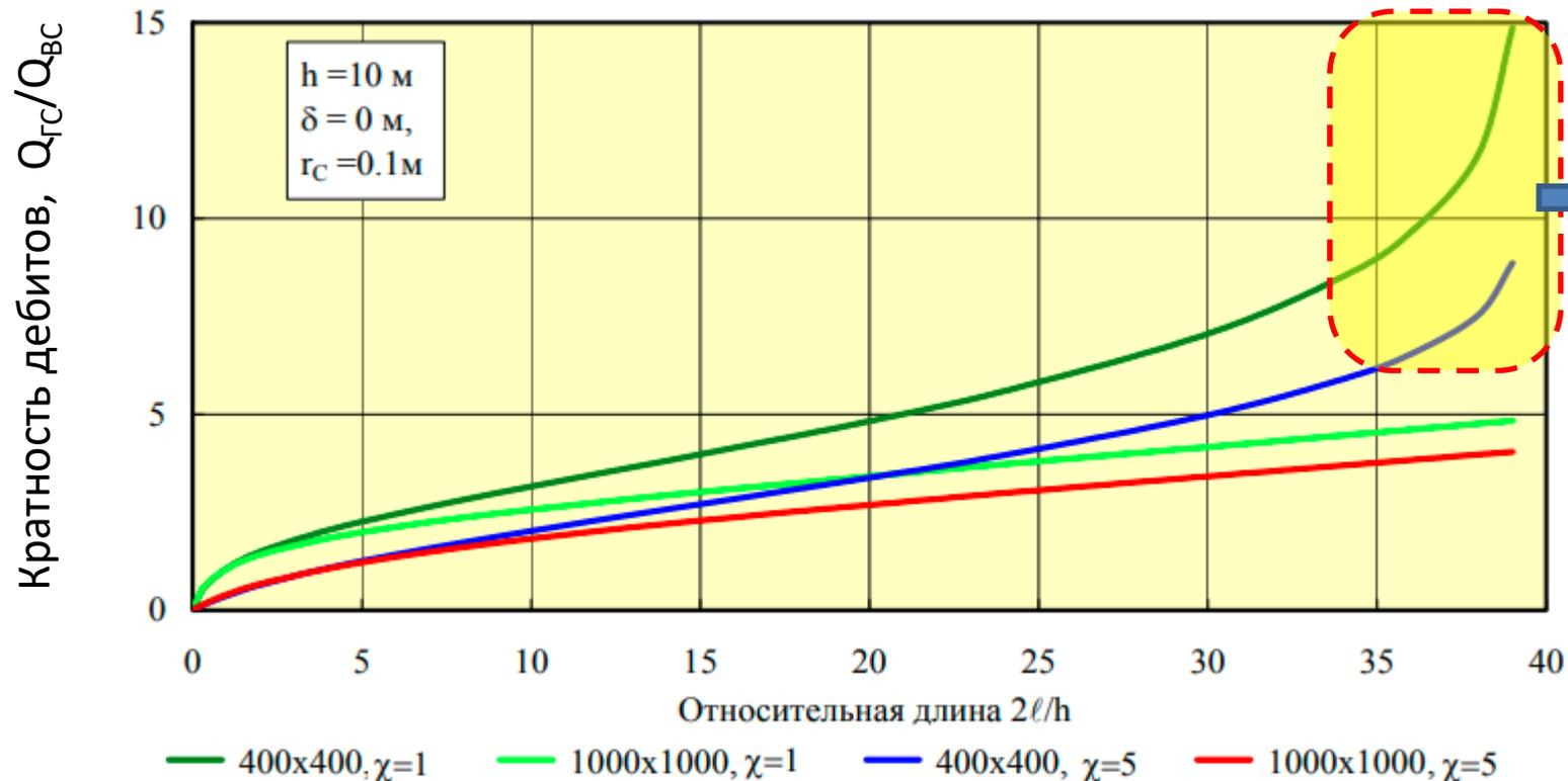
Видимо, численная погрешность расчётной схемы при  $2l > 35h$
