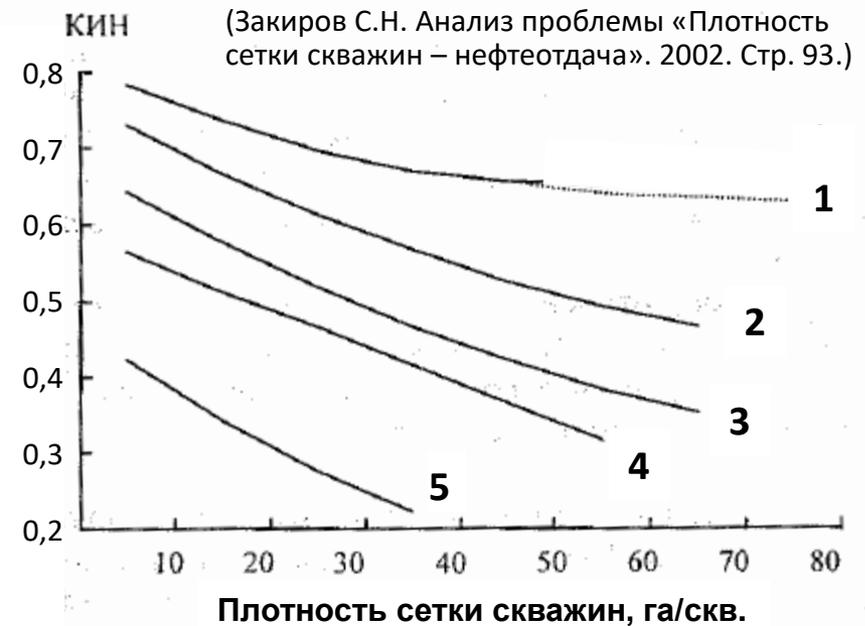
Шифр кривых – гидропроводность,  $\text{мкм}^2 \cdot \text{м} / (\text{сПа} \cdot \text{с})$ :
